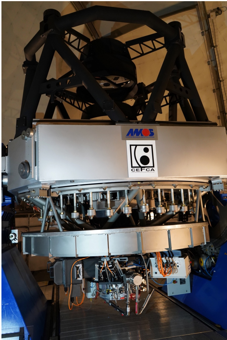
JPCam instalada en el foco Cassegrain del telescopio JST/T250 del Observatorio Astrofísico de Javalambre. Crédito: Centro de Estudios de Física del Cosmos de Aragón (CEFA).
